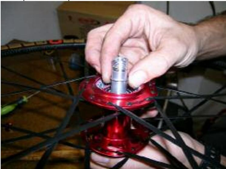
Inserte el núcleo nuevamente en el eje y rosque la tapa del lado derecho. El par recomendado de apriete es de 3Nm. Coloque la tapa del lado izquierdo con la mano y monte el cassette y el cierre rápido.....
