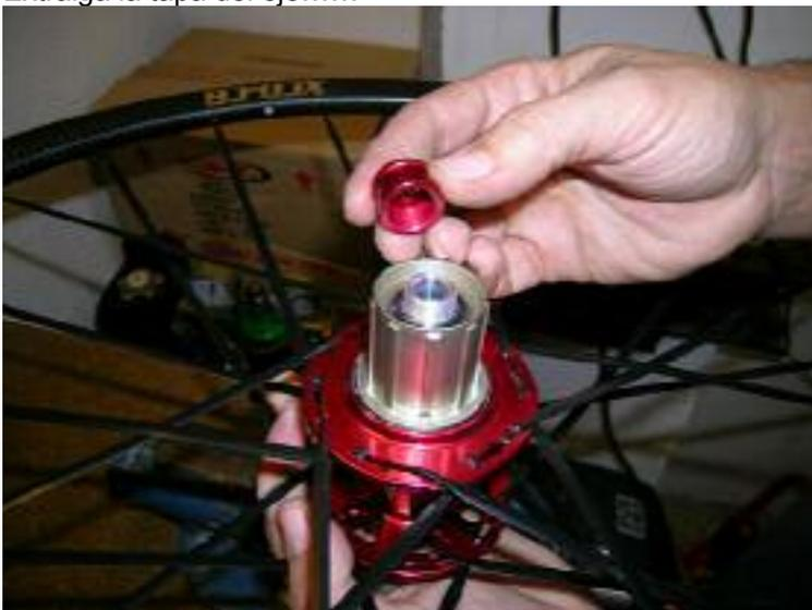
En este momento el núcleo se retira fácilmente con la mano dejando a la vista los trinquetes y la rueda dentada del interior del buje .....
