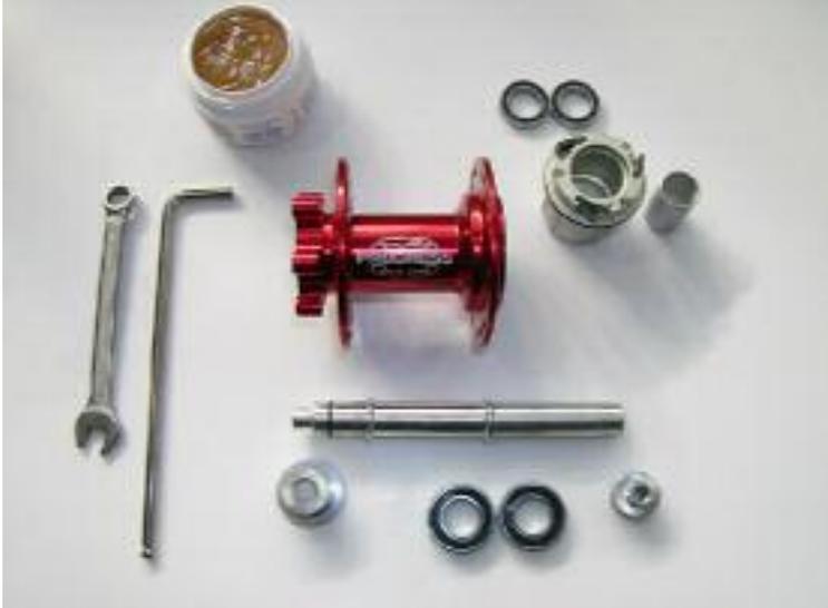
Extraiga la rueda de su bicicleta y desmonte el cassette ; puede aprovechar para limpiarlo en profundidad . Si usted desmonta el cassette con frecuencia para su limpieza (algo totalmente recomendable), puede aprovechar la ocasión para engrasar la rueda libre de su buje TURBINE y chequear el estado de la misma ,así como el de los rodamientos.
