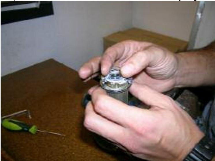
Compruebe el estado de los rodamientos y sustitúyalos si presentan holgura lateral o su rodar presenta puntos de dureza. Para la extracción de los rodamientos necesitará una maza de plástico y un punzón metálico. Golpeando con la maza sobre el punzón los rodamientos se desmontan con facilidad.....
