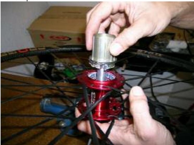
NOTA: Usted puede cambiar fácilmente de estándar "shimano" a "campagnolo" en sus ruedas Progress de carretera; solamente sustituyendo el núcleo por el adecuado.
