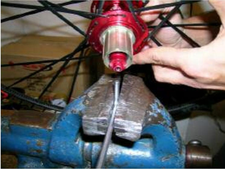
Sujeta el eje con la llave plana de 13mm por la acanaladura del lado izquierdo.....
